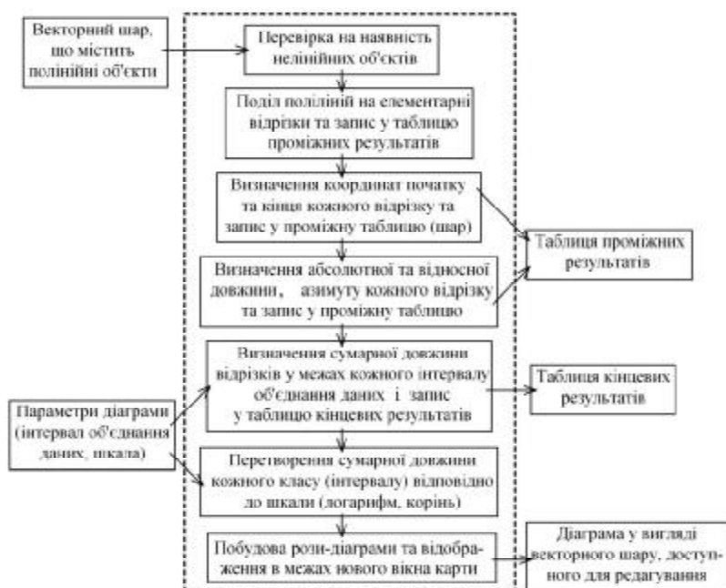
Рис. 3. Принципова схема алгоритму, покладеного в основу програмного модуля для побудови кругових структурних діаграм
