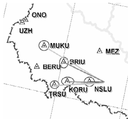
Рис. 4. Карта взаємного розташування епіцентру землетрусу та сейсмостанцій, записи з яких вибрано для розв'язання оберненої задачі
