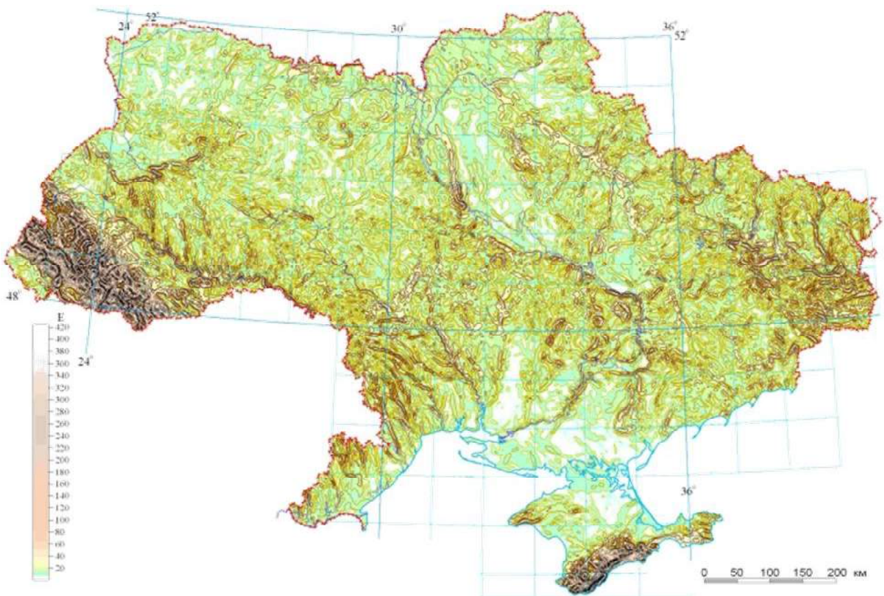
Рис. 4. Карты абсолютных значений силы тяжести (а) и ее модуля полного горизонтального градиента (б) со снятым планетарным фоном [9]
