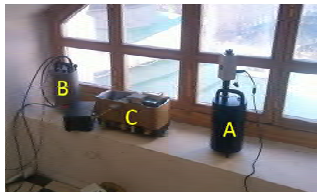
Рис. 4. Зовнішній вигляд сейсμοприймачів для вимірювання зміщення, швидкості та прискорення поширення коливань: А – акселерометр; В – велосиметр; С – лазерний вимірювач вертикальних зміщень
