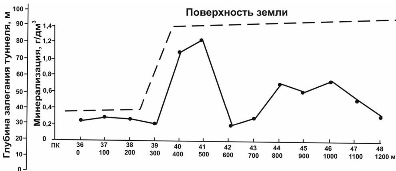
**Рис. 2.** Графики минерализации поровых растворов мергельно-глинистых пород киевской свиты эоцена вдоль линии туннеля метрополитена по пласту слабопроницаемых пород на участке Сырец – Дорогожичи (ПК – пикет)
