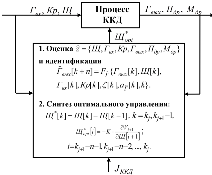
Рис. 2. Алгоритмическая структура АО ИСУ процессом ККД по ФОР с прогнозирующей моделью
