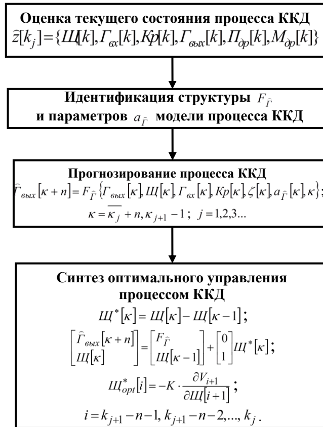
Рис. 3. Процедуры алгоритма синтеза адаптивного оптимального управления процессом ККД по ФОР с прогнозирующей моделью
