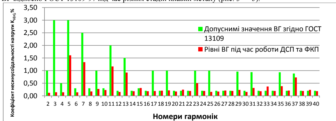
Рис. 3. Гістограма для нелінійних гармонійних спотворень напруги, на стороні напруги 35 кВ під час стадії розплавлення металу
