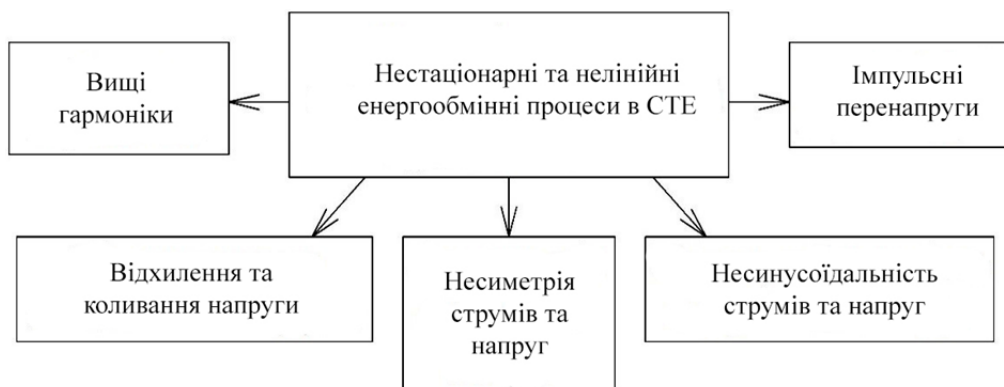
Рис. 1. Вплив електромагнітних процесів на якість електроенергії.
