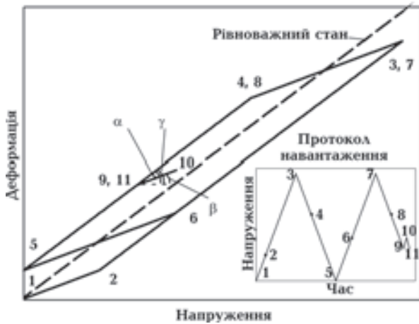
Рис. 1. Якісна залежність напруження—деформація для комбінації пружного механізму з прилипанням та пружної деформації.
