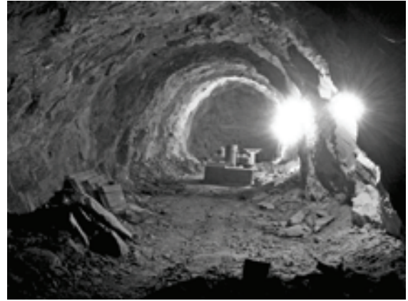
Рис. 2. Лаборатория № 2 Северокавказской геофизической обсерватории. Эльбрусский вулканический центр, уникальный по структуре объект. Углубление под г. Андырчи 4,1 км. Глубина боковой вырубке в штольне "Вспомогательная" — 80 м. Геофизическая аппаратура (наклономеры, гравиметры, магнитные вариометры) размещена на двух бетонных постаментах. Низкий уровень помех приему полезной геофизической информации, стабильный температурный режим (38 °С) позволяют вести здесь широкий спектр геофизических наблюдений.
