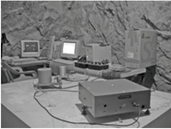
Рис. 1. Лаборатория № 1 Северокавказской геофизической обсерватории, заглубленная на 1,5 км под г. Андырчи. Эльбрусский вулканический центр. Координаты обсерватории: 43° 16' с. ш.; 42° 41' в. д. На переднем плане — магнитовариационная станция системы В. Н. Боброва, на заднем — наклонмеры системы Д. Г. Гриднева.
