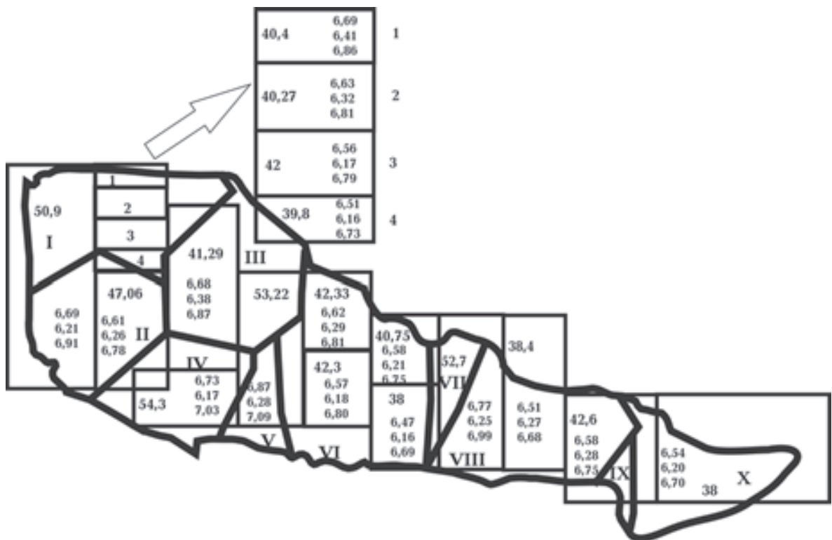
Рис. 3. Блок-схема осредненной модели земной коры УЩ, где представлены глубина залегания поверхности раздела М (км), а также значения средних скоростей (сверху вниз, км/с) в интервале земная поверхность — граница М, 0—15 км — поверхность раздела М: I — Вольнский мегаблок, II — Подольский мегаблок, III — Росинский мегаблок, IV — Бугский мегаблок, V — Голованевская шовная зона, VI — Ингульский мегаблок, VII — Криворожско-Кременчугская шовная зона, VIII — Среднеприднепровский мегаблок, IX — Орехово-Павлоградская шовная зона, X — Приазовский мегаблок.
