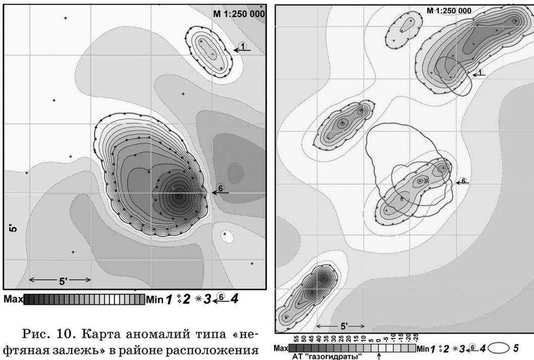
Рис. 10. Карта аномалий типа «нефтяная залежь» в районе расположения аварийной скважины в Мексиканском заливе, построенная по результатам обработки спутниковых данных. 1 – шкала относительных значений пластового давления; 2 – точки регистрации аномально-го отклика; 3 – положение аварийной скважины; 4 – относительная величина пластового давления в аномальной зоне
