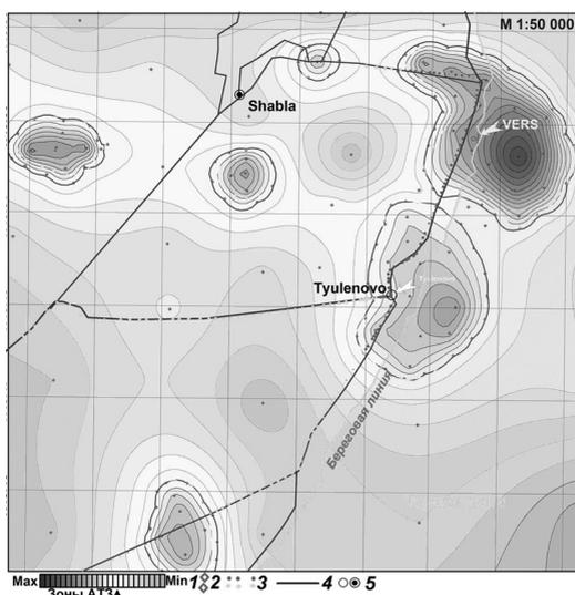
Рис. 7. Карта аномальных зон типа «залежь УВ» в единицах относительных значений среднего пластового давления в пределах нефтеперспективного блока в Средиземном море (по результатам дешифрирования спутниковых данных). 1 – шкала относительных значений среднего пластового давления; 2 – проектные разведочные скважины (?); 3 – тектонические нарушения по результатам дешифрирования данных ДЗЗ; 4 – границы блока
