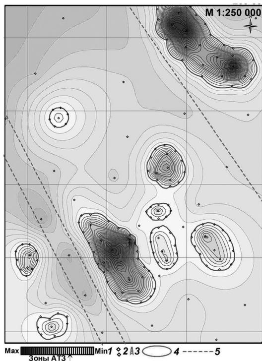
Рис. 1. Карта аномальных зон типа «залежь нефти» в районе структуры «Медынская-Море 1» (Печорское море, Россия) (по спутниковым данным). 1 – шкала интенсивности аномального отклика; 2 – пункты регистрации отклика; 3 – проектная скважина на структуре «Медынская-Море 1»; 4 – прогнозируемые участки максимального нефтенасыщения; 5 – возможные тектонические нарушения
