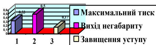
Рис. 1. Відносний ступінь важливості обраних критеріїв для вибору способу підривання свердловин
