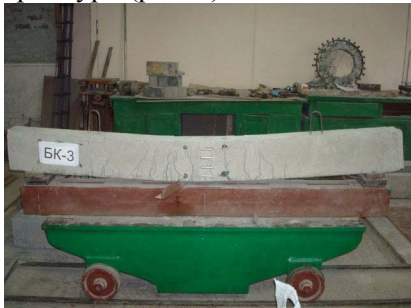
Рис. 1 Загальний вигляд непідсиленої балки контрольної серії БК, зруйнованої за нормальним перерізом.
