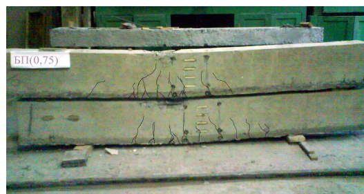
Рис. 3 Загальний вигляд підсиленої балки серії БП-0,75 зруйнованої циклічним навантаженням (вигляд балок серії БП-0,85 та БП-0,9 подібний)
