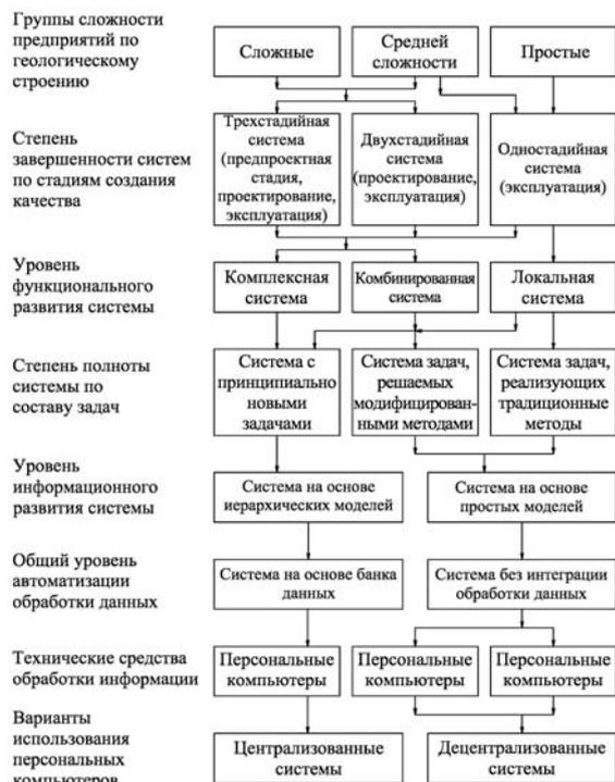
**Рис.1.** Направление развития автоматизированной обработки маркшейдерско-геологической информации на различных горнодобывающих предприятиях
