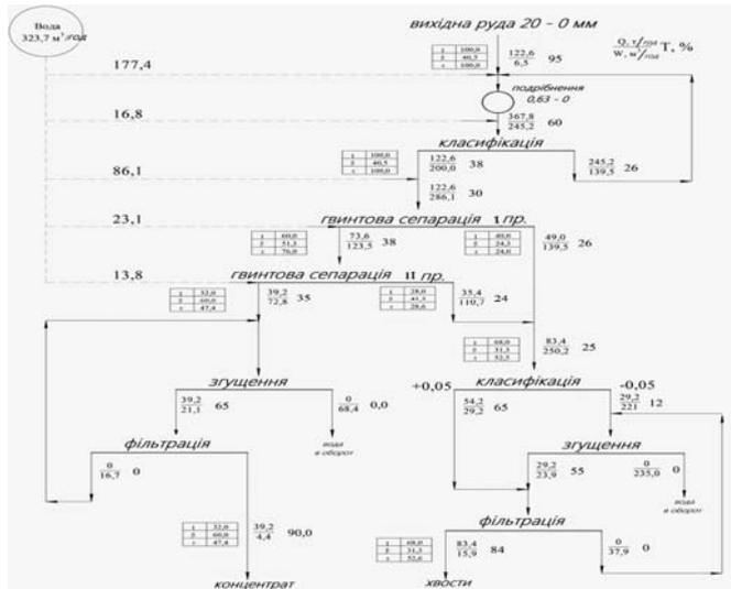
Рис. 1. Рекомендована технологічна схема збагачення некондиційних гематитових руд
