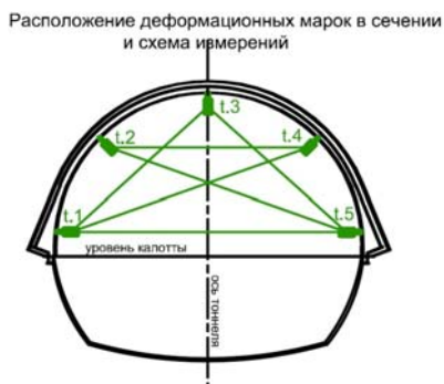
Рис. 3. Расположение деформационных марок (реперов) в сечении калотты
