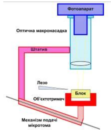
Рис. 2. Схема пристрою для виготовлення серій гістологічних зрізів
