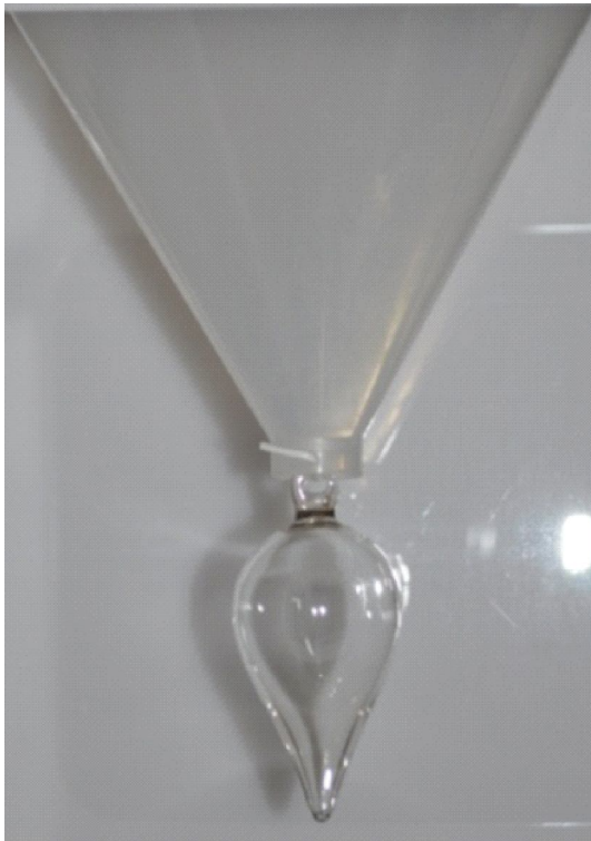
Рис. 2. Збиральна лійка (справа внутрішня поверхня) і скляний краплеподібний «сепаратор» метаболічної камери «НПК Открытая Наука»
