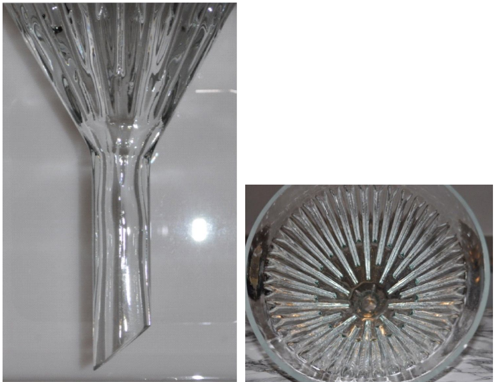
Рис. 5. Скляна ребриста лійка (справа внутрішня поверхня) SIMAX (Чехія), яку встановили в оригінальну метаболічну камеру
