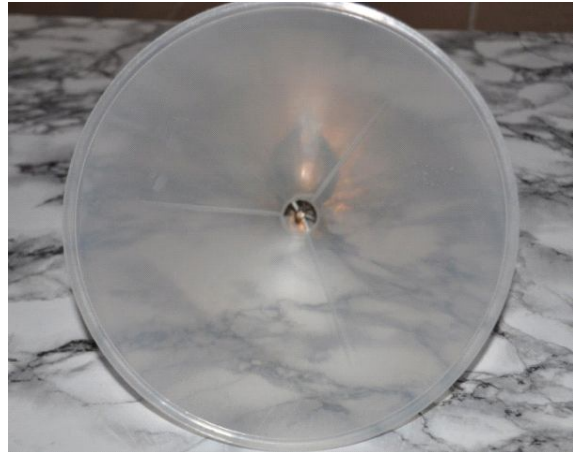
Рис. 2. Збиральна лійка (справа внутрішня поверхня) і скляний краплеподібний «сепаратор» метаболічної камери «НПК Открытая Наука»
