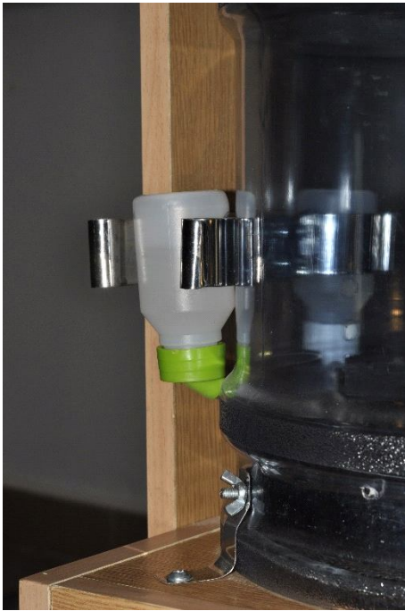
Рис. 6. Фіксація поїлок і відсіку для тварин із корпусом оригінальної метаболічної камери
