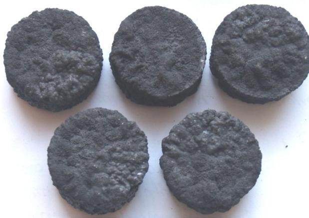
Рис. 11. Металлизированные брикеты из концентрата, полученного из гематитовых кварцитов шахты «Заря-Октябрьская». Диаметр брикетов около 20 мм.
