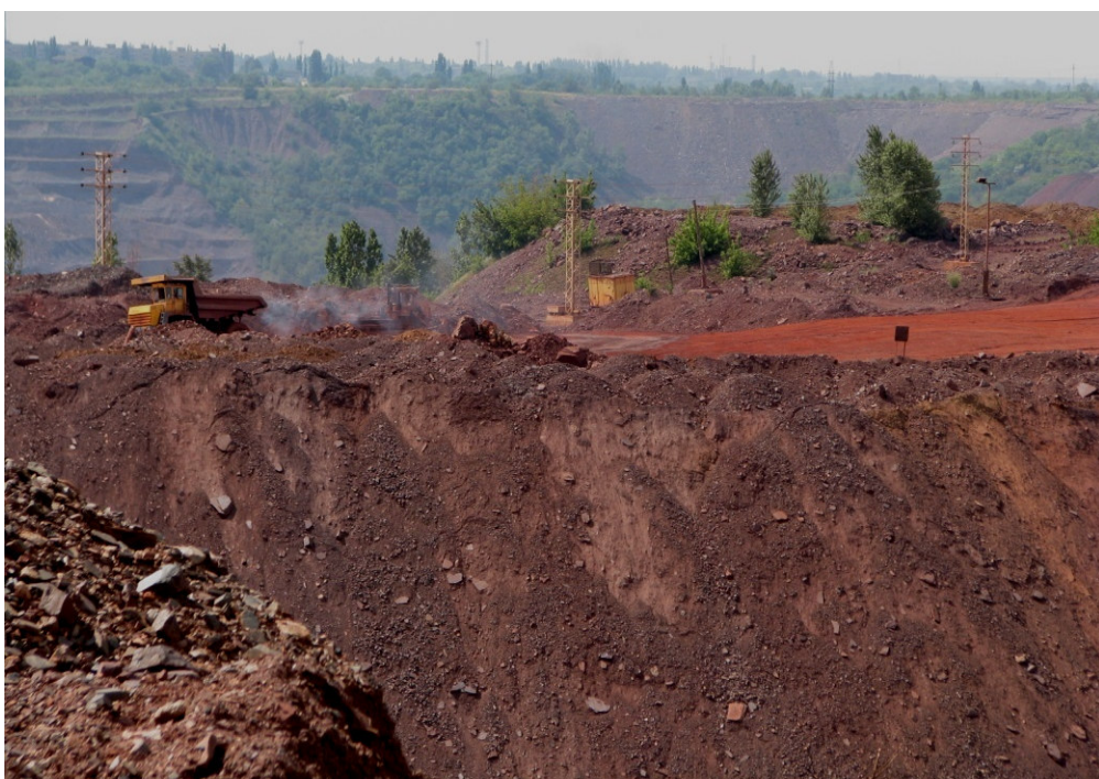
Рис. 6. Складирование гематитовых кварцитов в отвалах действующего карьера «Южный» (шахтоуправление комбината «АрселорМиттал Кривой Рог»).
