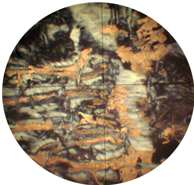
Рис. 2. Структура секущего прожилка карбонатизированного хризотила из антигоритового серпентинита.
