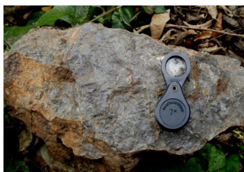
Рис. 5. Текстура бедных силикат-магнетит-карбонатных руд. а – пятнисто-массивная; б – массивно-пористая.
