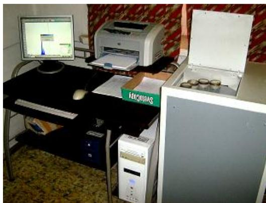
Рис. 4. Спектрометр РЛП-21.
