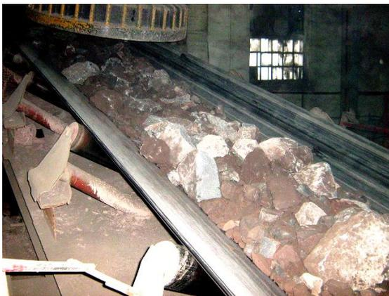
*Рис. 6. Конвейер № 1А на ЖОФ-1, транспортирующий руду после крупного дробления.*
