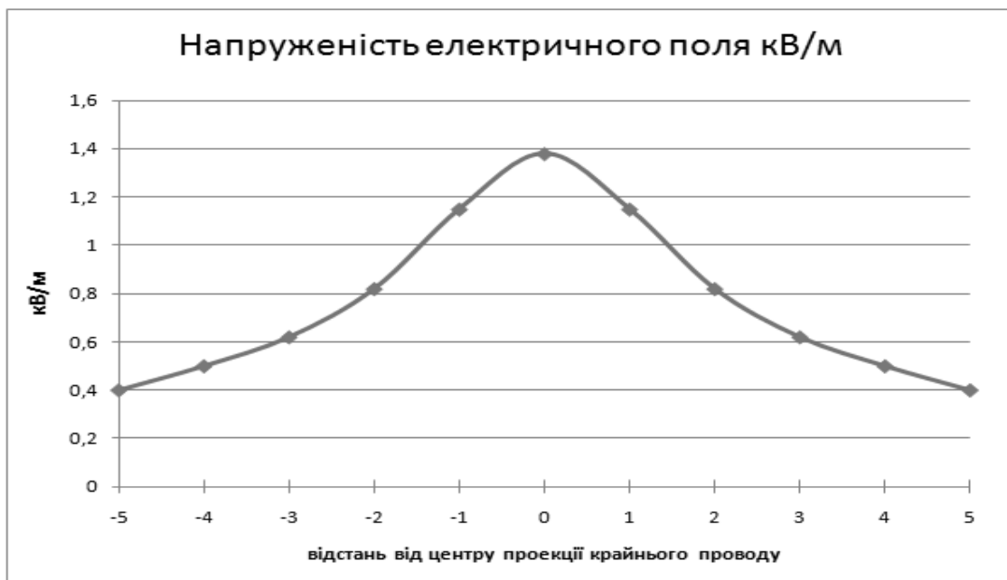
Рисунок 2. Розподіл рівнів електричного поля 50 Гц, що створюється КЛ Тилігульської вітрової електростанції на висоті 0,5 м від поверхні землі.
