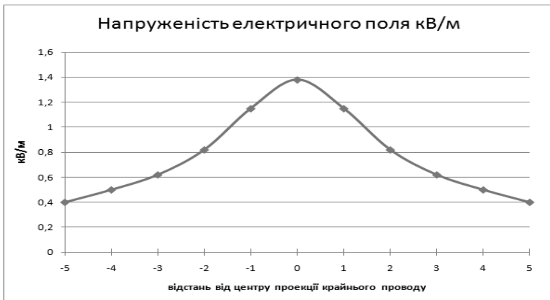
Рисунок 6. Розподіл рівнів електричного поля 50 Гц, що створюється КЛ Покровської вітрової електростанції на висоті 0,5 м від поверхні землі.
