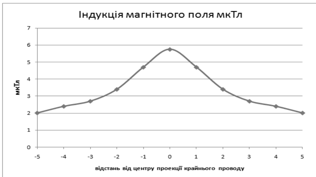
Рисунок 3. Розподіл рівнів магнітної індукції 50 Гц, що створюється КЛ Тилігульської вітрової електростанції на висоті 0,5 м від поверхні землі.
