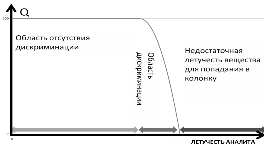
Рисунок 4. Схематическое представление дискриминации компонентов пробы по летучести. Q-отношение массы анализата в газовой фазе к массе рэчыва ў ісходнай пробе.
