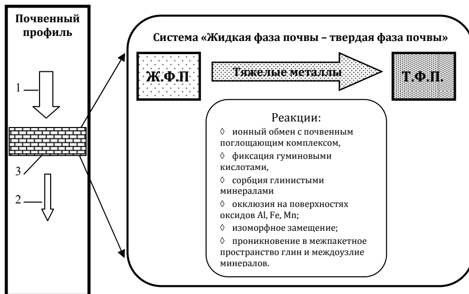
Рис. 2. Принцип действия и основные компоненты педогеохимического барьера
