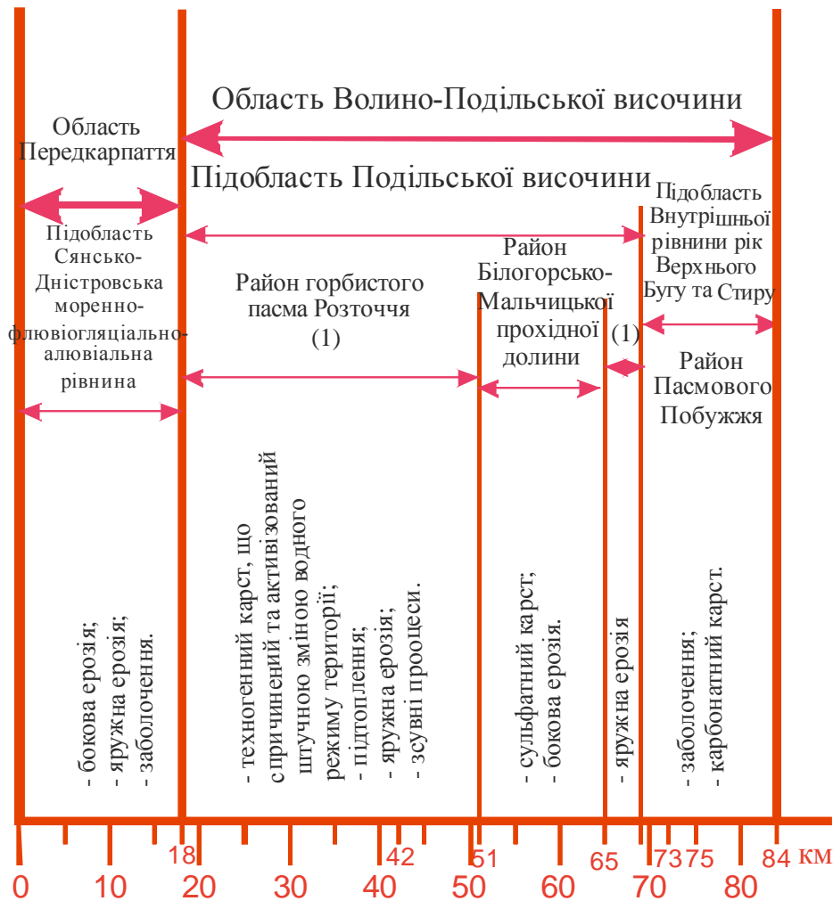
Рис. 1. Схема геоморфологічного районування, природних і техногенно-активізованих екзогенних геолого-географічних процесів в межах єврокоридора Львів –Краковець [12,13]
