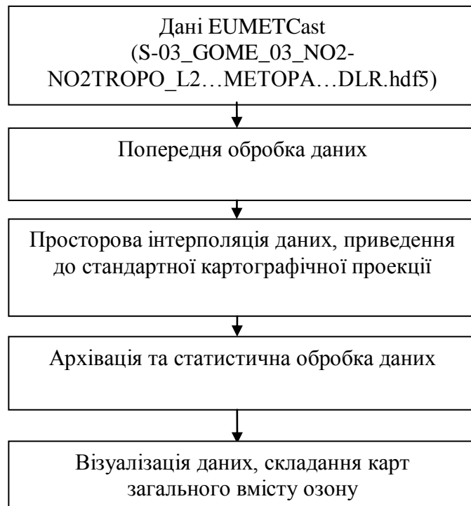
Рис.1. Система оперативного моніторингу загального вмісту озону над Україною, яка заснована на вимірах з супутника МЕТОР-А
