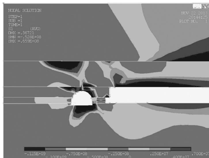
Рисунок 4 – Распределение главных напряжений  $\sigma_1$  вокруг горной выработки, поддерживаемой за лавой (этап 2)
