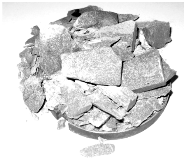
Рисунок 12 – Характер разрушения песчаника, отобранного из кровли пласта C_{10}^B шахты Днепроовская для образца «Вак+CO 2 »
