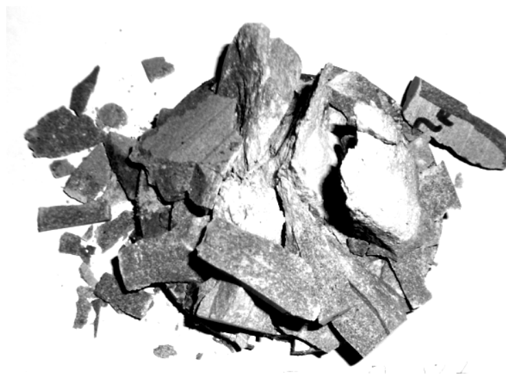
Рисунок 9 – Характер разрушения песчаника, отобранного из кровли пласта C_{10}^B шахты Днепроовская для газонасыщенного образца без влагонасыщения
