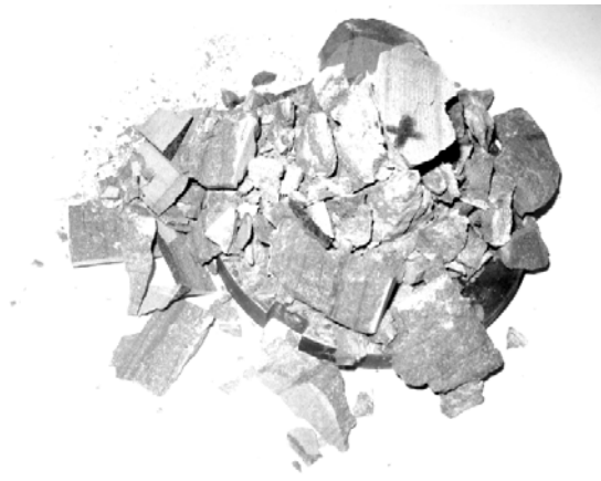
Рисунок 16 – Характер разрушения песчаника, отобранного из угле вмещающего песчаника шахты «Павлоградская» для образца «Вак+N 2 »
