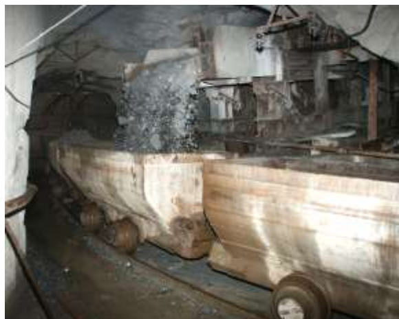
Рисунок 1 – Вибропитатель для выпуска руды из блока
