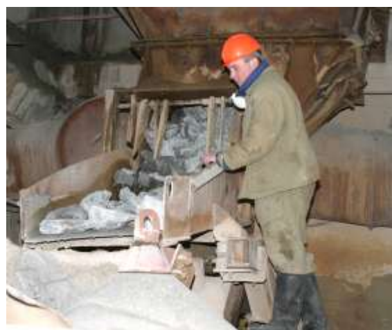
Рисунок 2 – Вибропитатель-грохот под бункером
