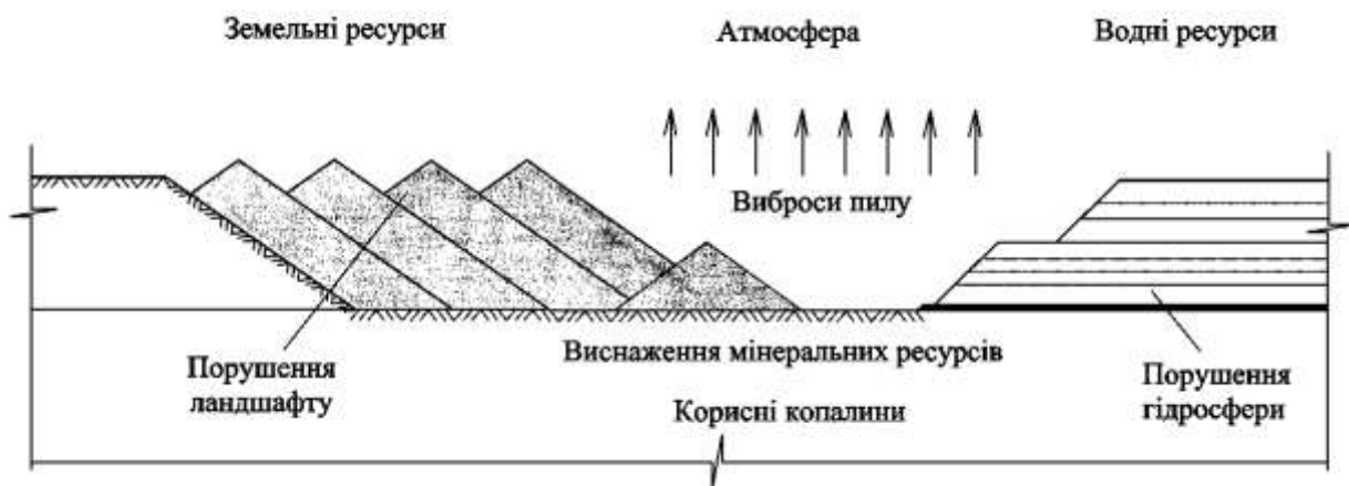
Рисунок 1 - Схема, що демонструє порушення природних ресурсів відкритими гірничими розробками
