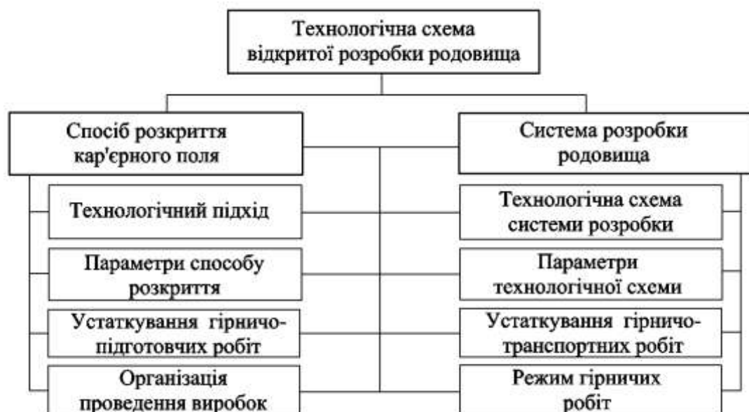
Рисунок 3 - Схема технологічного взаємозв'язку між способом розкриття кар'єрного поля та системою розробки родовища
