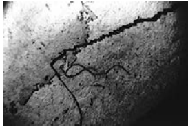
Рис. 2. Сутуровидные трещины в кварцевой жиле джеспилитов Кривого Рога. Шлиф, увел. 100 x Fig. 2. Suture cracks in quartz vein jaspilites of Krivoy Rog. Grinding, SW. 100 x
