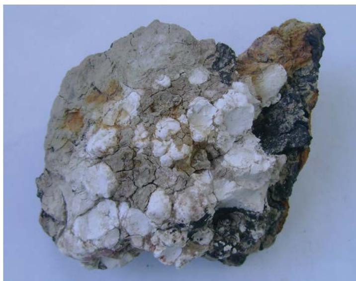
Рис. 2. Стяжения алунита в глинистой породе рудного пласта. Обр. ЗП-31, размеры 7×8 см
