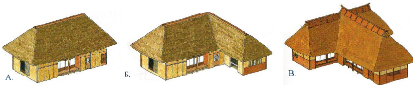
Рис.1 Регіональні типи японських хат, що вирізняються характеристиками плану: холодні північні регіони (схеми за Татемацу Вахей). А – «суго-я»; Б – «магарі-я»; В – «цуно-я».
