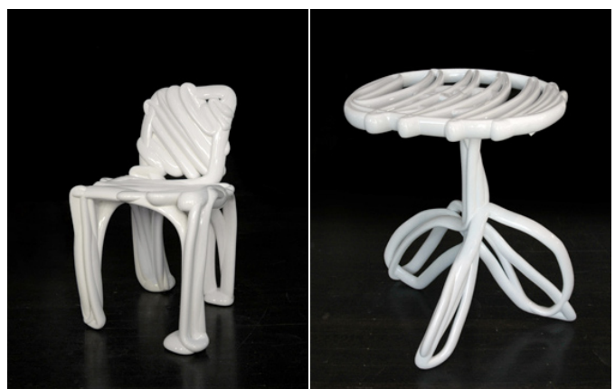
Рис.5. Зразки друку меблів на основі Motion Capture та швидкого прототипування
