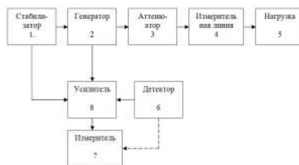
Рисунок 1 – Структурная измерительная схема измерения диэлектрических характеристик 1 – стабилизатор питания, 2 – генератор с рабочей частотой 2450 МГц (Г4-9), 3 – аттенюатор Д5-17, 4 – измерительная линия, 5 – нагрузка: блок с образцом материала, 6 – детектор Э9-11, 7 – измеритель: осциллограф С1-54, 8 – усилитель УЗ-7А
