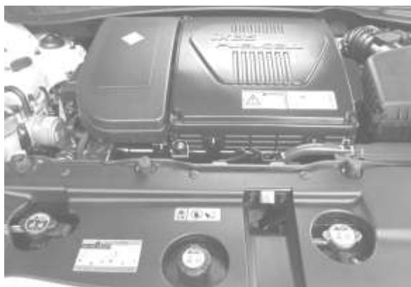
Рисунок 2 – Топливный элемент подает ток на литийно-полимерный аккумулятор, затем ток подается на электродвигатель в 136 лошадиных сил
