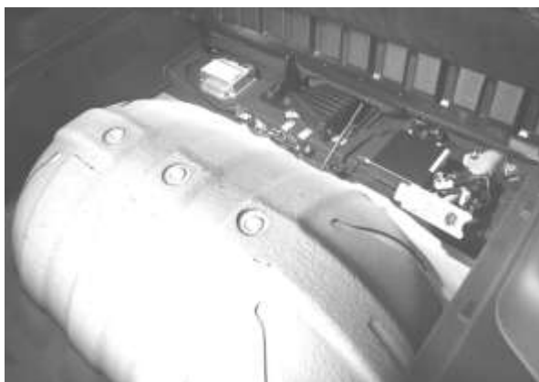
Рисунок 3 – Один из двух баков с водородом, находящихся под днищем автомобиля
