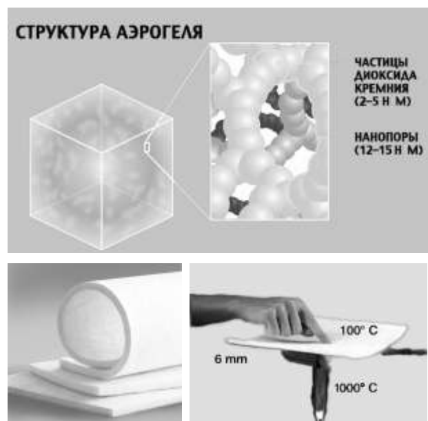
Рисунок 6 – Аерогель: а – структура; б – зовнішній вигляд; в – основна властивість аерогелю – висока ізоляційна якість при малій товщині
