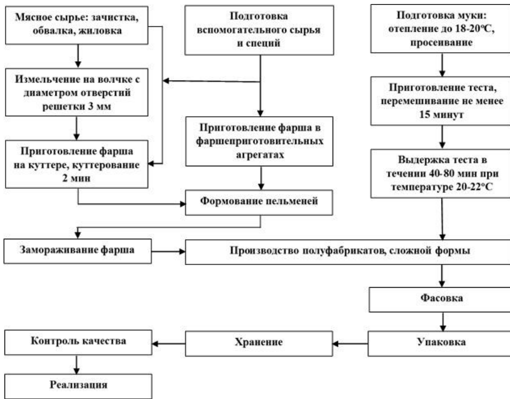
Рисунок 3 – Структурная схема работы предприятия по производству пельменной продукции особых форм.
