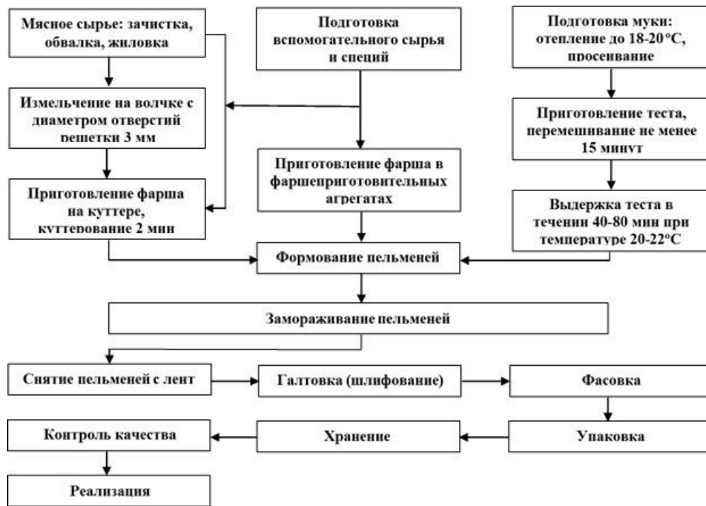
Рисунок 2 – Структурная схема работы предприятия по производству обычной пельменной продукции
