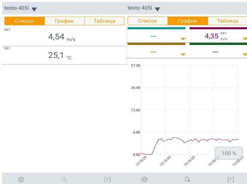
Рисунок 6 – Зняття заміру руху повітря в компресорному відсіку
