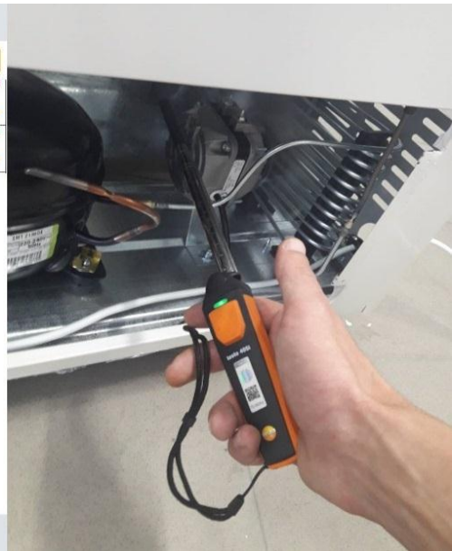
Рисунок 6 – Зняття заміру руху повітря в компресорному відсіку
