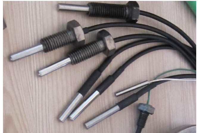
Рисунок 10 – Зовнішній вигляд зондів для вимірювання температур
