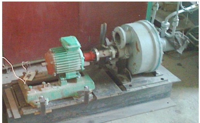
Рисунок 2 – Турбогенератор на основі струминно-реактивної розширювальної машини.
