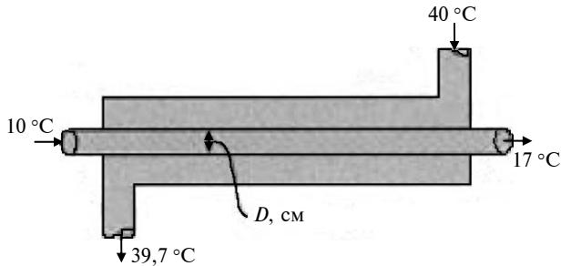
Рис. 4. Фрагмент теплообменника аппарата искусственного кровообращения
