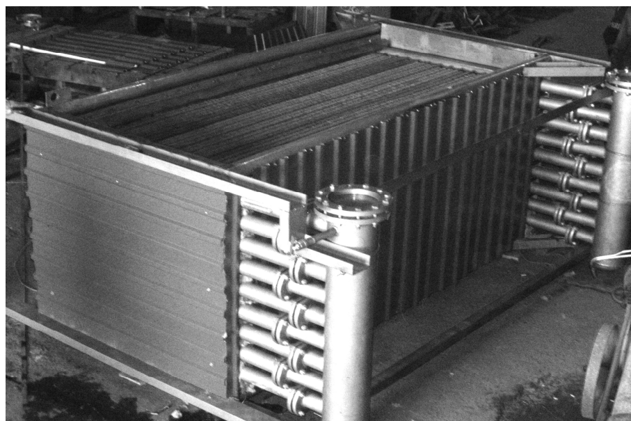
Рис. 2. Економайзер з плоскоовальних труб з неповним оребренням
