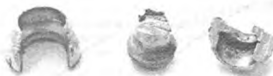
Рис. 3. Пластична деформація стопорної шайби та голівки штока.
