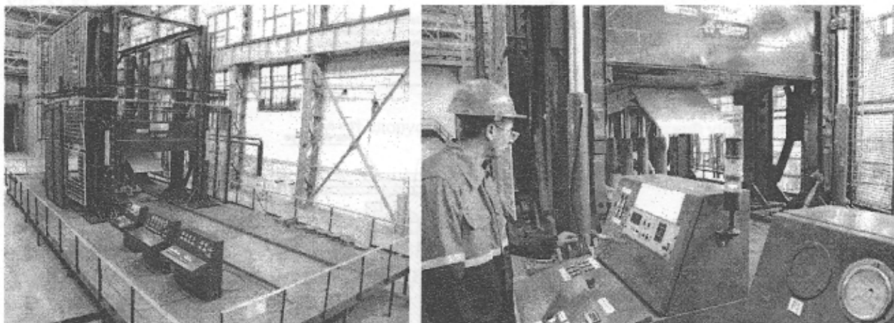
Рис. 1. Испытания секции крепи на испытательном стенде «Gluckauf».
