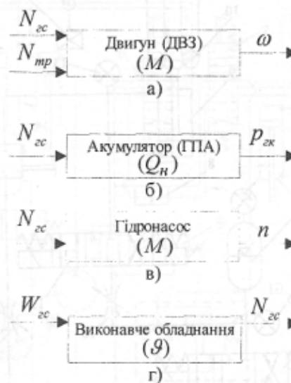
Рис. 6. Функціональні схеми елементів системи акумулювання.
