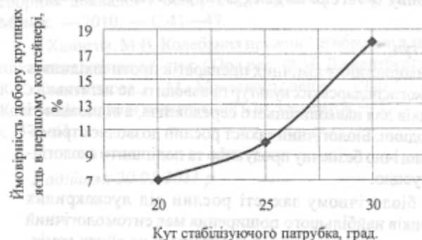
Рис. 3. Залежність ймовірності добору крупних яєць від кута стабілізуючого патрубку.
