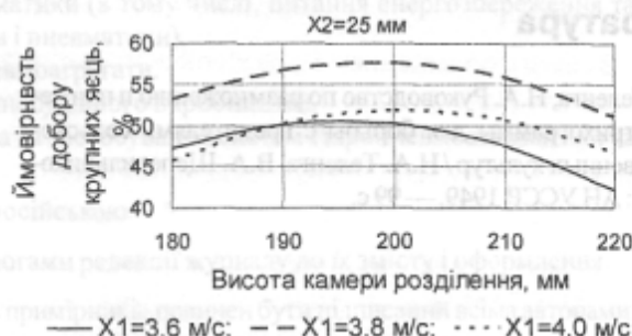
Рис. 6. Залежність ймовірності добору крупних яєць від висоти камери розділення та швидкості повітряного потоку.
