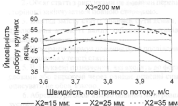
Рис. 5. Залежність ймовірності добору крупних яєць від швидкості повітряного потоку та висоти пластини-заслінки.
