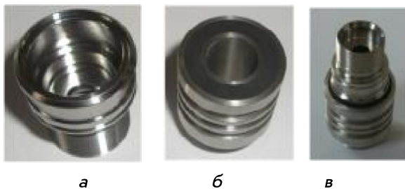
Рисунок 2 — Деталі проточної частини клапана: а — сідло; б — золотник із гумовим кільцем; в — клапан в зборі.
