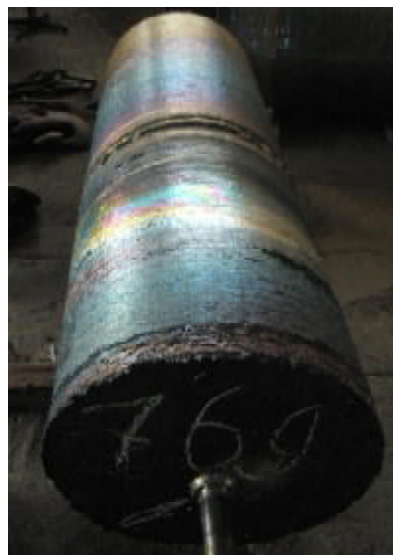
Рисунок 2 — «Гофрована поверхня» титанового злитку.
